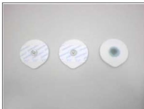
**Figura 28** – Superfície descartável de eletrodos
