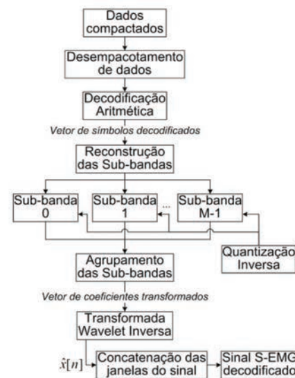
Fig. 2. Diagrama de blocos da decodificação de sinais S-EMG.
