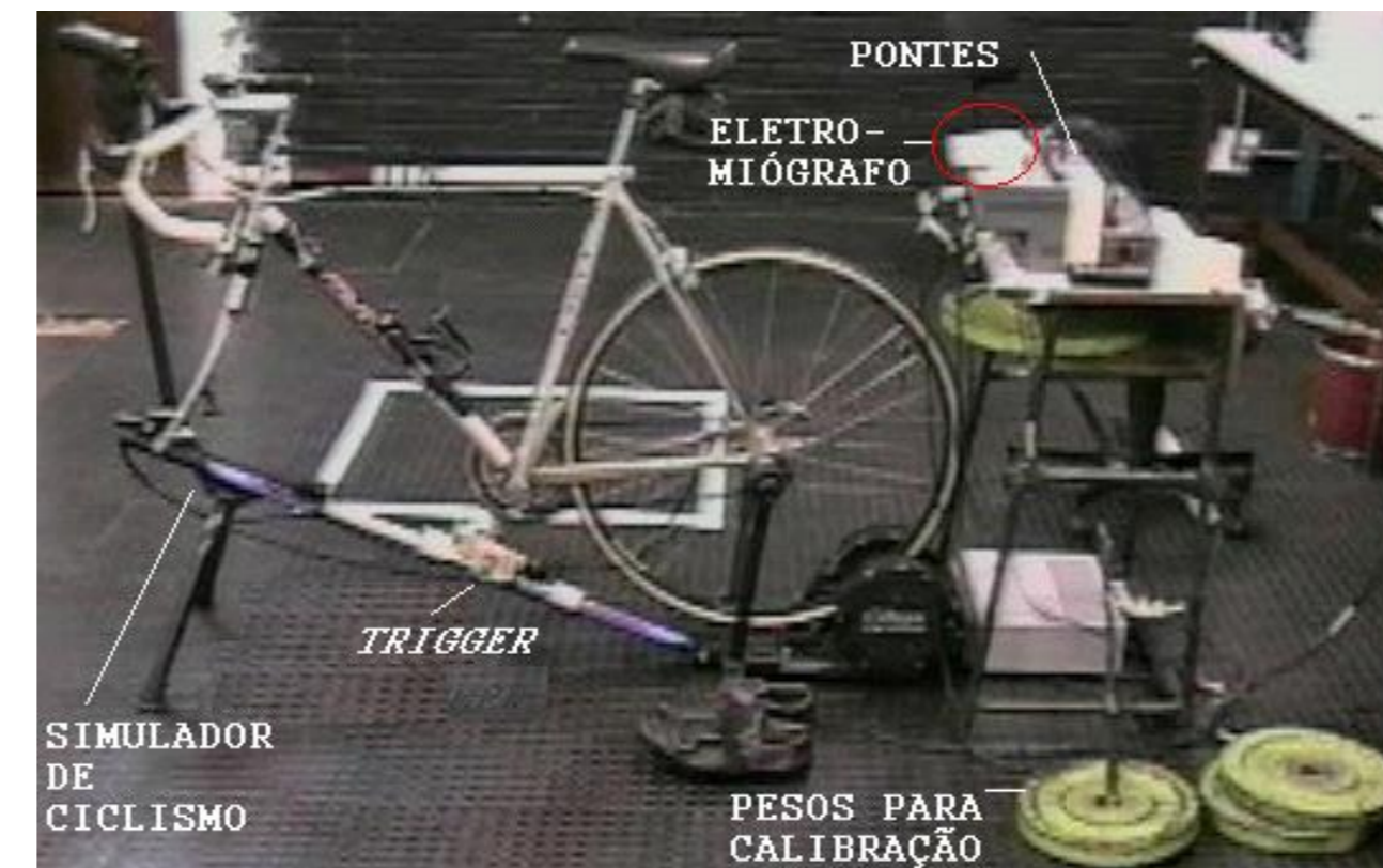
Fig. 3. Instrumentação utilizada para a digitalização de sinais de S-EMG em aplicações dinâmicas — simulador de ciclismo
