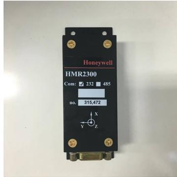
Figura 9 – Magnetômetro.
