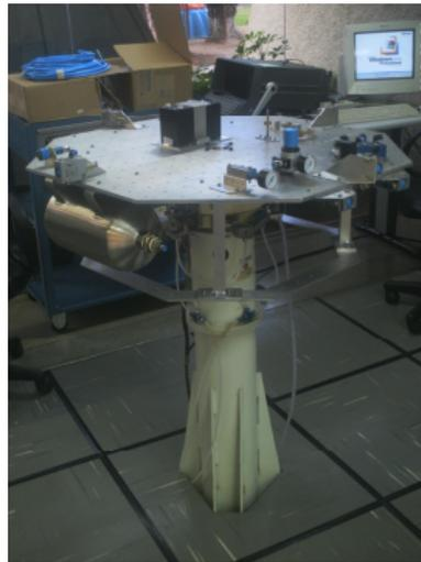
Figura 1 – Mesa com atuadores de gás frio montada no INPE (1).
