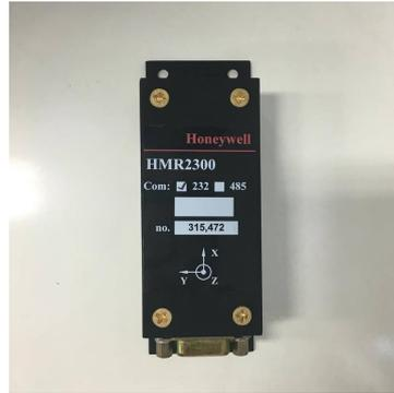
Figura 9 – Magnetômetro.
