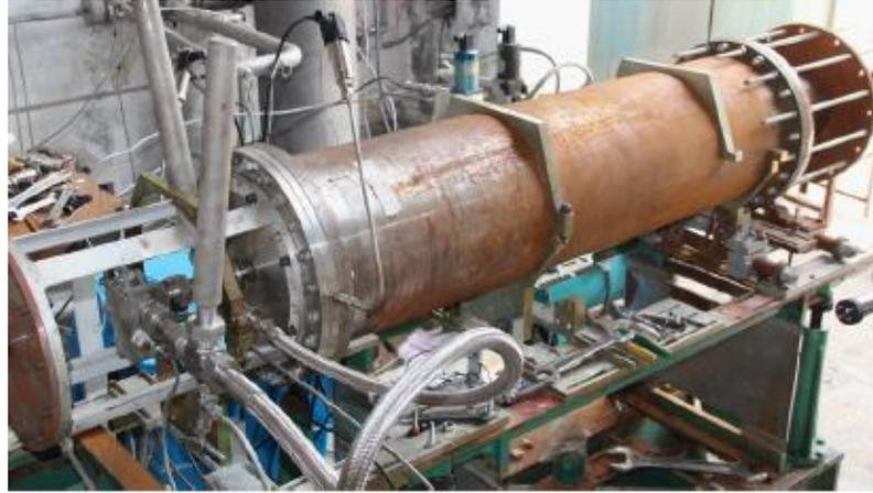
Figura 20. Motor experimental na plataforma de teste (TIAN et al., 2014).
