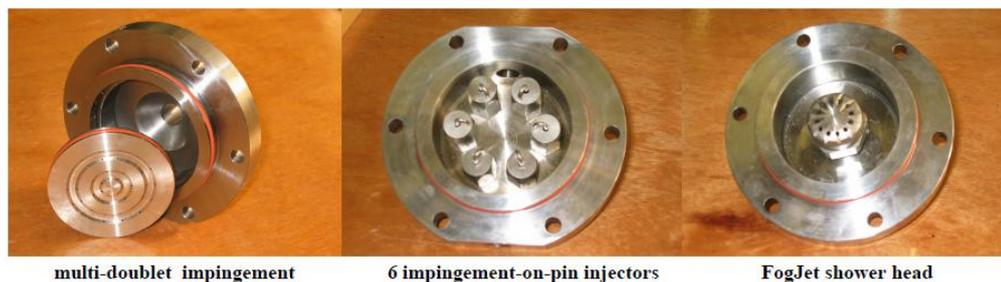
Figura 7. Injetores testados no estudo (EINAV et al., 2009).
