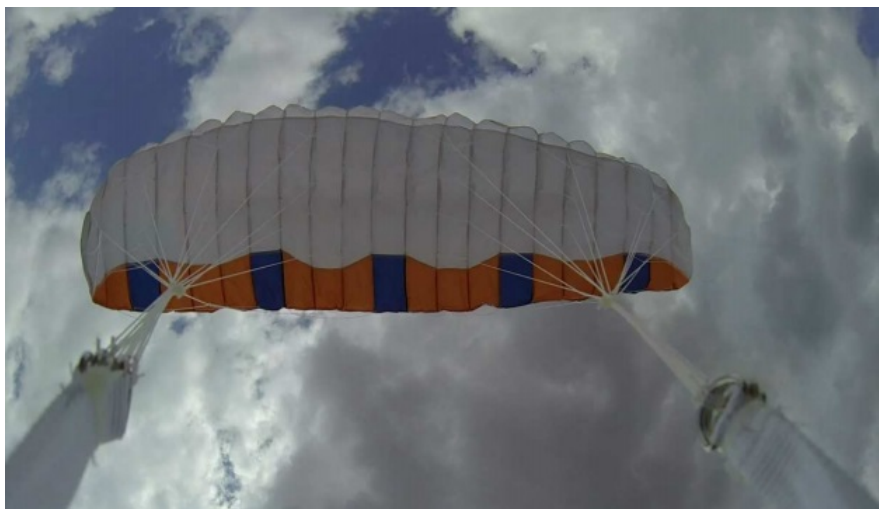
Figura 5 – Paraquedas do tipo parapente usado na missão do LAICAnSat-1[10].
