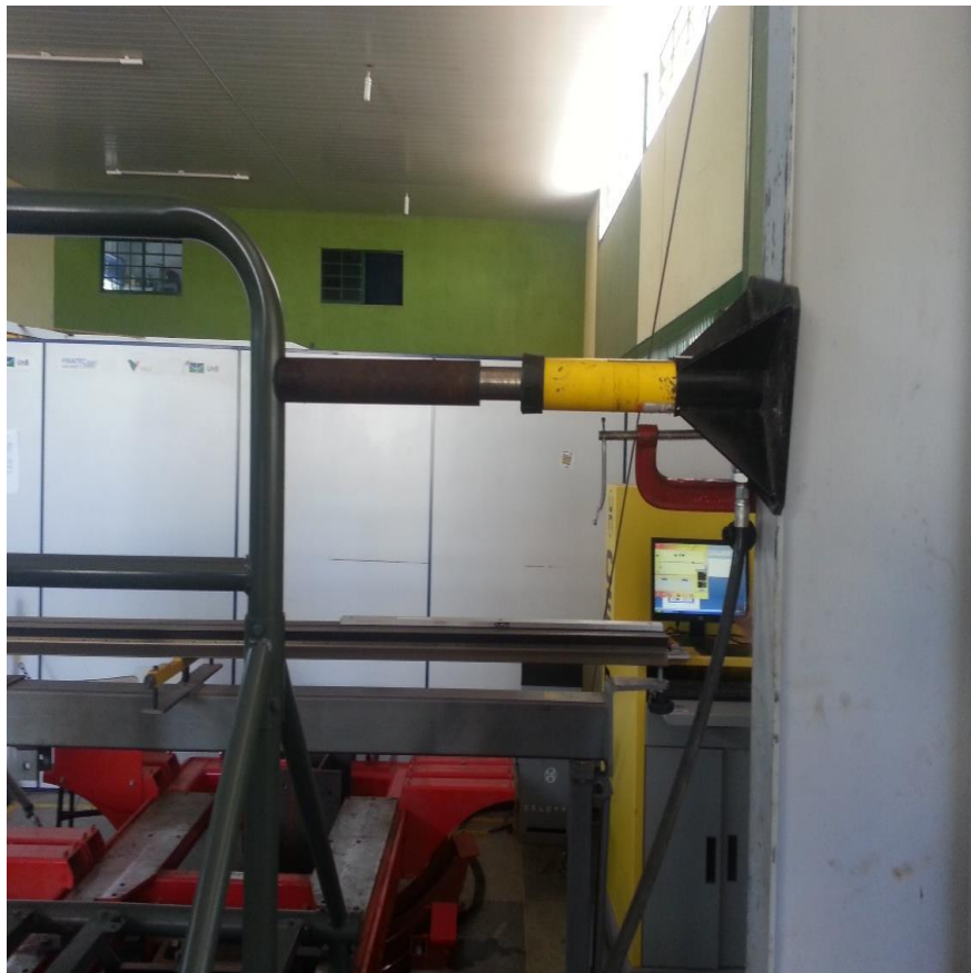
Figura 48 – Fixação do pistão para ensaio frontal.
