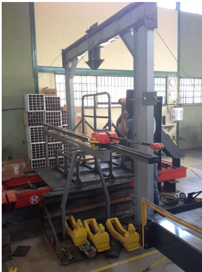
Figura 39 – Posicionamento do trilho já com o robô acoplado.
