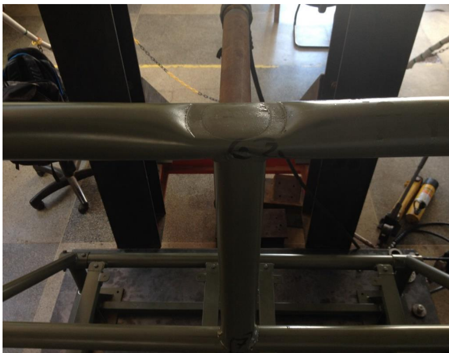
Figura 46 – Detalhe do ponto 2 após retirada da carga.
