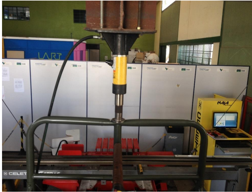
Figura 45 – Aplicação da carga vertical com auxílio de um alongador.
