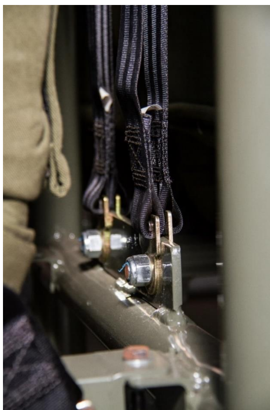
Figura 26 – Ancoragem cinto de segurança.
