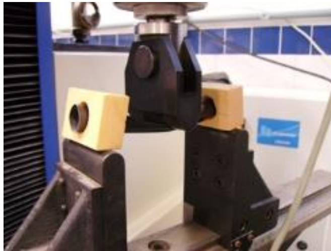
Figura 2 – Ensaio de Flexão (Fonte: Página UFSC). 2
