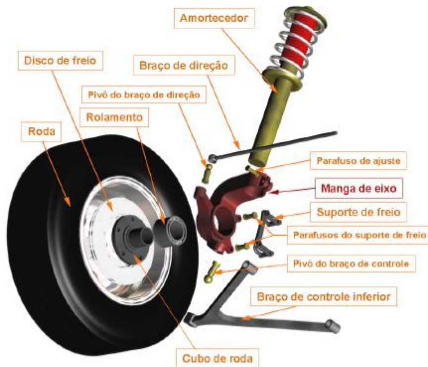
Figura 14. Esquemático de uma suspensão, Fonte: Klava, (2003).
