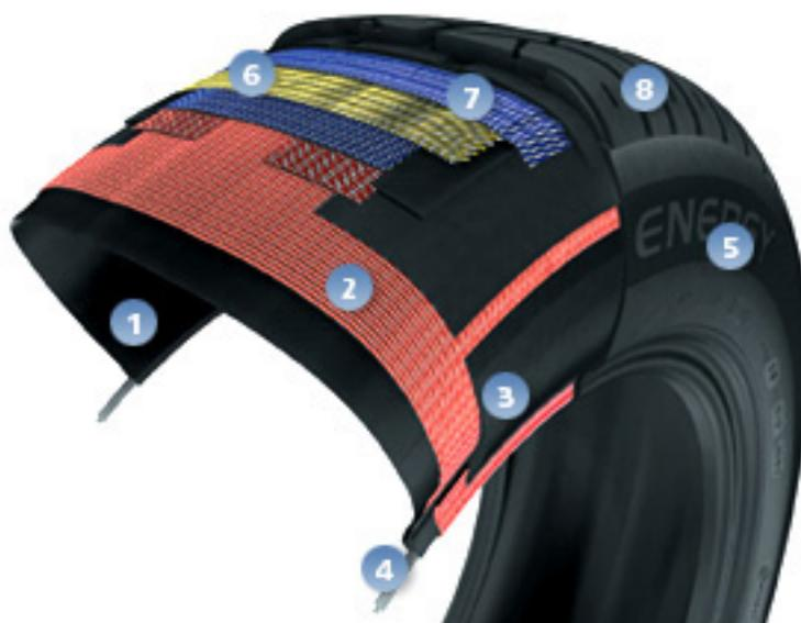
Figura 1: Estrutura do Pneu.
