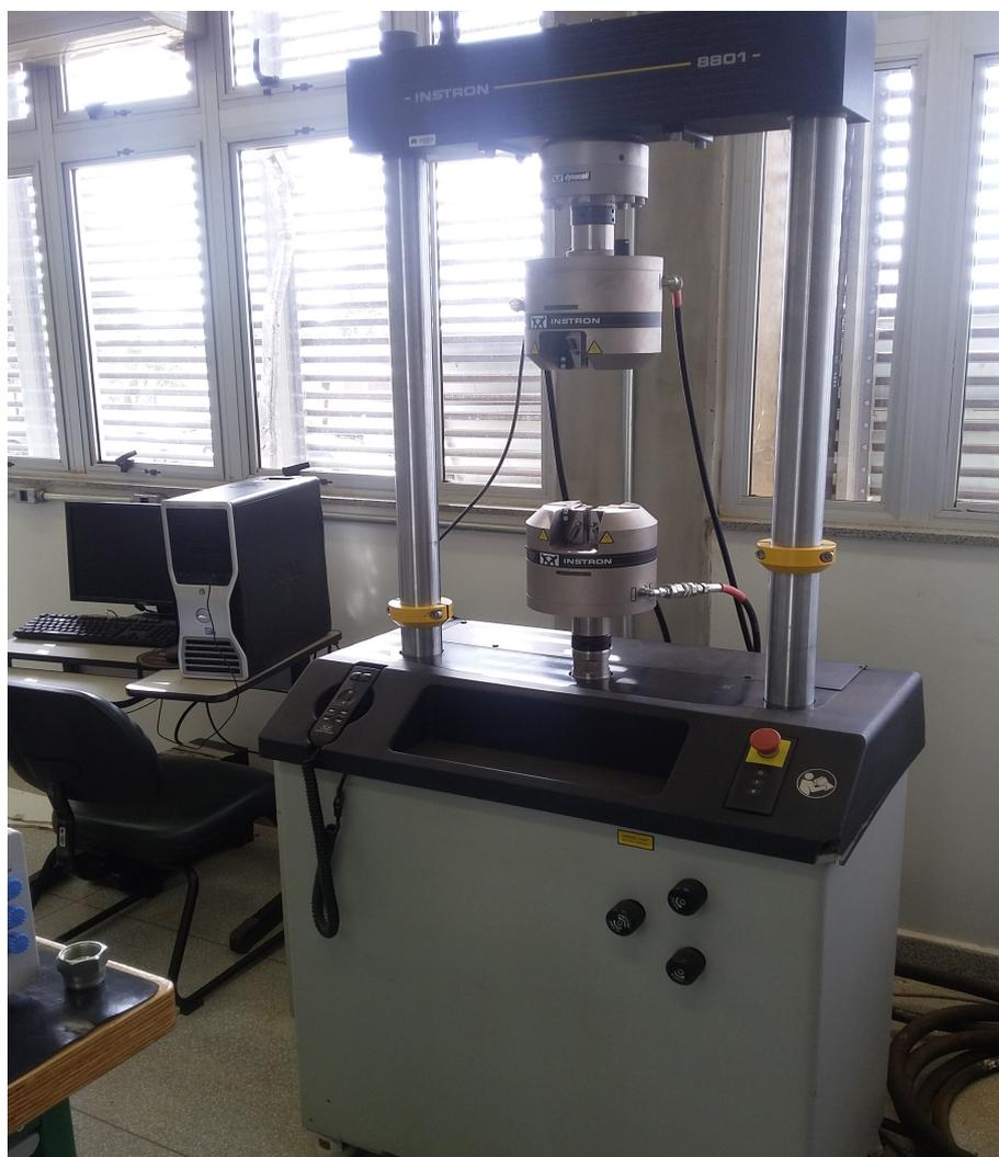
Figura 6: Máquina de Ensaio Universal.
