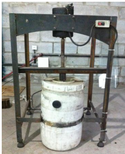
Figura 24 - Máquina de desgaste construída por Oliveira (2015)
