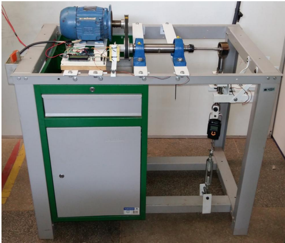
Figura 59 - Máquina de ensaio de fadiga obtida ao final do trabalho
