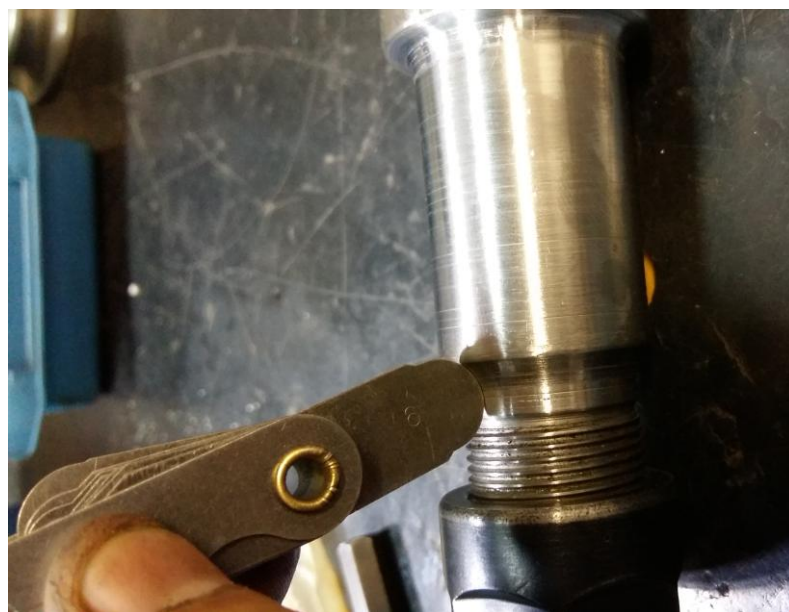
Figura 56 - Verificação do raio de adelgaçamento do eixo
