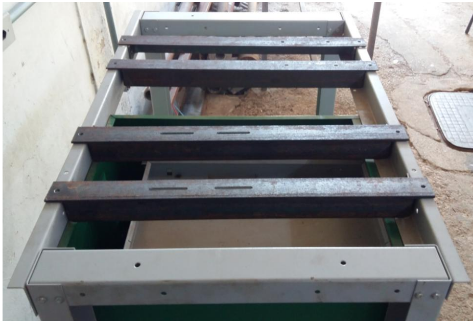
Figura 58 - Cantoneiras de sustentação dos mancais e do motor
