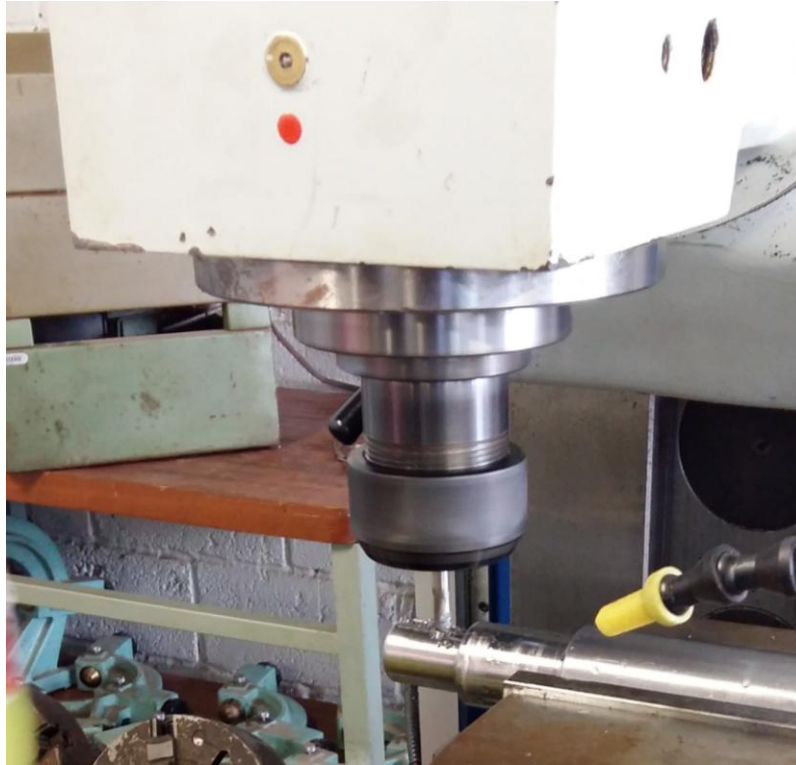
Figura 55 - Processo de fresamento do rasgo de chaveta do eixo
