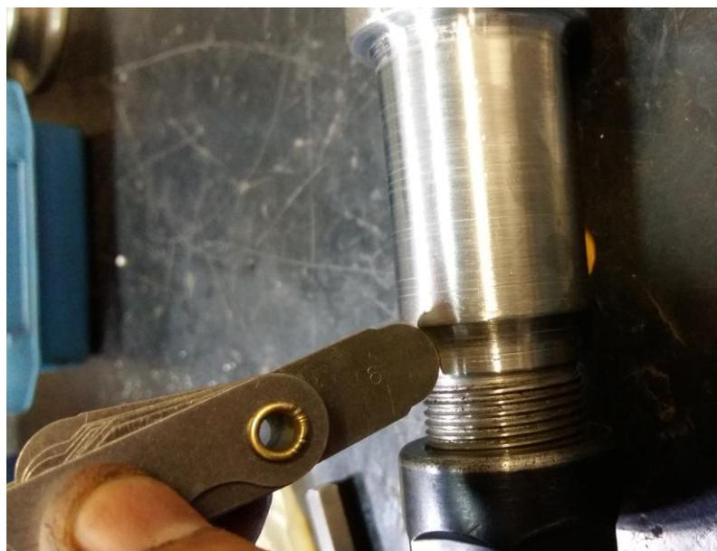
Figura 56 - Verificação do raio de adelgaçamento do eixo
