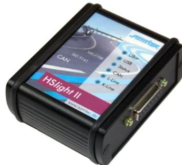
Fig. 13. Dispositivo para leitura da ECU, Samtec . (Fonte: site do fabricante).
