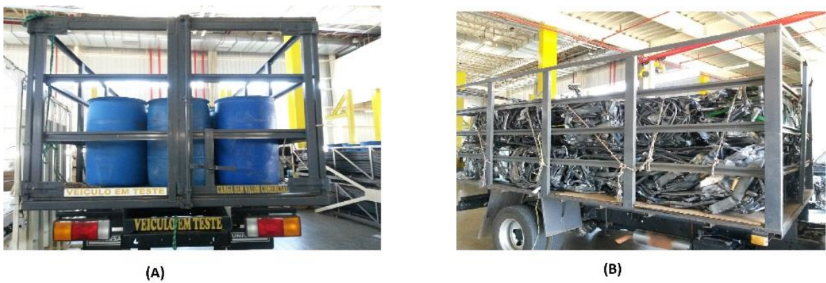
Fig. 10. A) Carga composta por galões de água. B) Carga de sucata de aço prensado.
