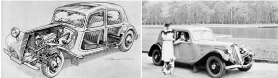
Figura 2.9 - Citroën Traction Avant: destaque em inovação à época devido ao chassi monobloco e à tração dianteira. Fonte: FlatOut.
