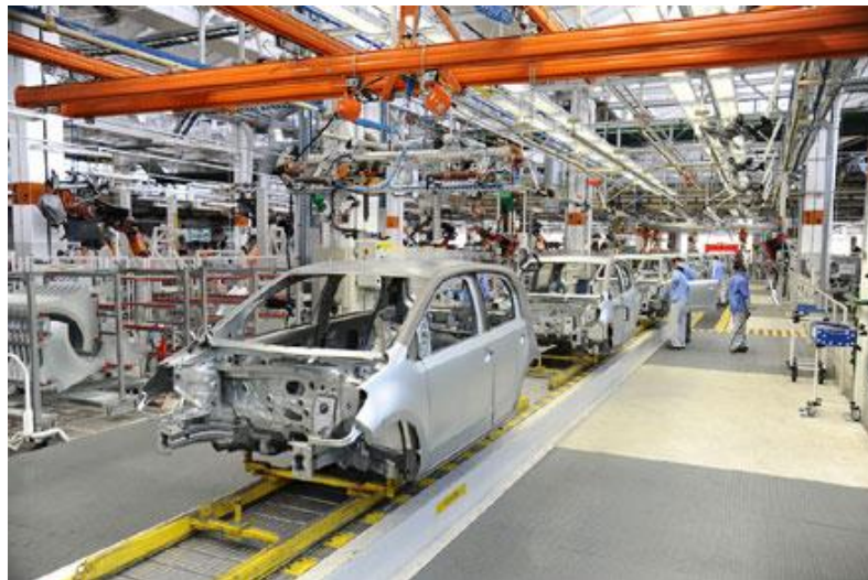
Figura 2.12 – Linha de produção do chassi monobloco do Volkswagen Up!, em Taubaté-SP. Fonte: Eco Curitiba, 2014.
