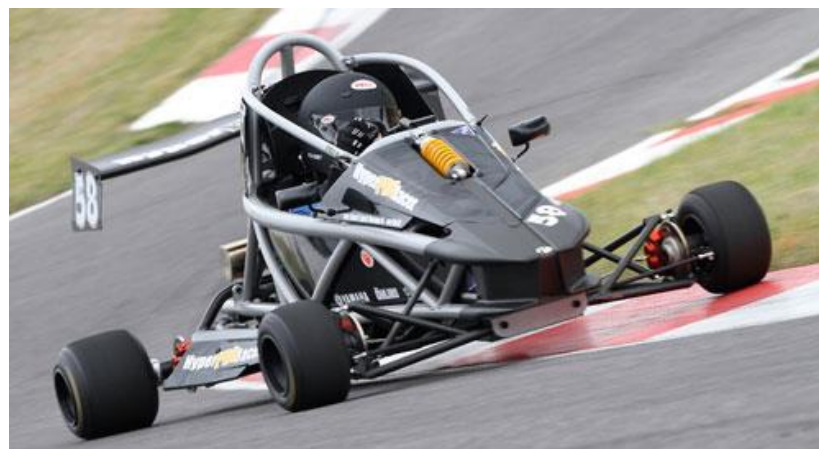
Figura 2.8 – Estrutura space frame do modelo alternativo ao kart da companhia australiana Hyper PRO Racer. Fonte: Kart Sport News.
