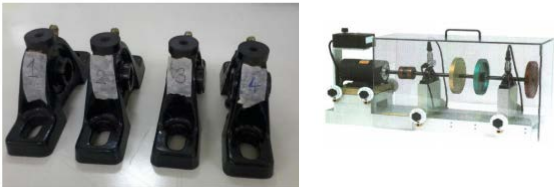
Figura 38. Mancais com defeitos diferentes e rotor-kit modelo ABVT [Fonte: BARILLI, 2013].
