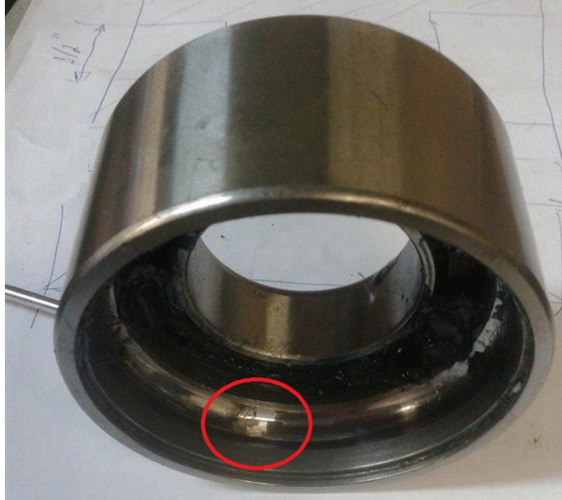
Figura 51. Falha provocada na pista externa.
