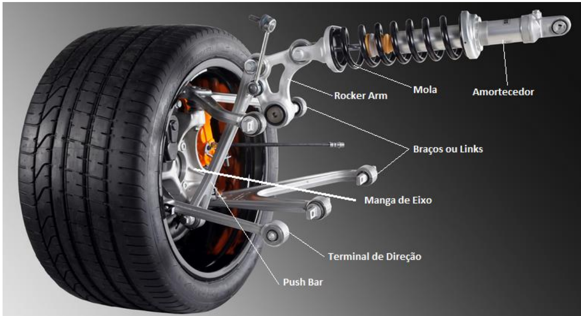
Figura 1. Sistema de suspensão duplo A. Fonte: Adaptado de http://www.ozgemini.com/forums/tech/viewtopic.php?p=245911 Acesso em: Agosto de 2015.
