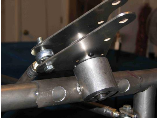
Figura 4. Sistema com Rocker Arm em detalhe. Fonte: http://www.atomictoyshop.com/A-Arms3.htm Acesso em: Agosto de 2015.
