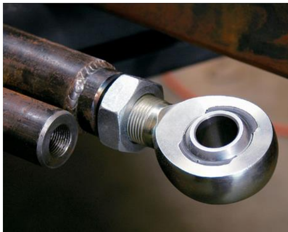
Figura 5. Barra de direção com terminal rotular. Fonte: http://the10castnetwallpaper.blogspot.com.br/2012/10/rod-ends.html Acesso em: Agosto de 2015.
