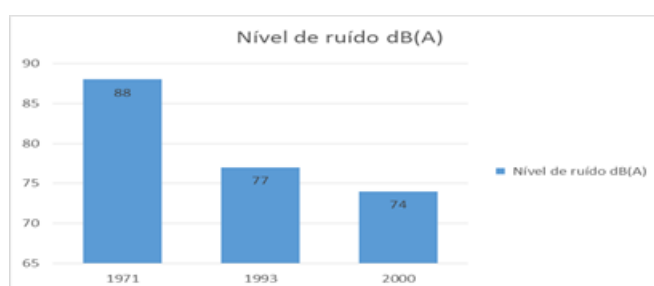
Figura 1: Representação da redução dos níveis máximos de ruído emitido por veículos (CARVALHO, 2003).
