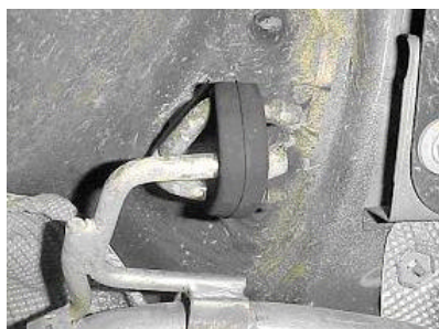
Figura 11: Ponto de fixação do sistema de exaustão do veículo via coxim (FONTE: Costa et al. (2003) p.8)
