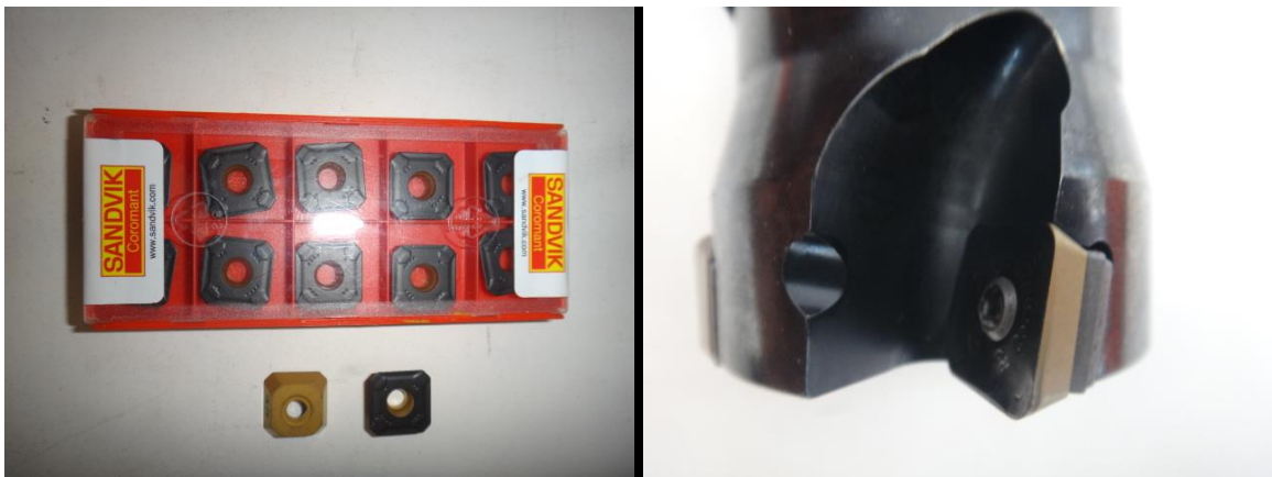
Figura 3.2 - Insertos de metal duro da classe ISO P para fresamento de aços. Fonte: Próprio Autor
