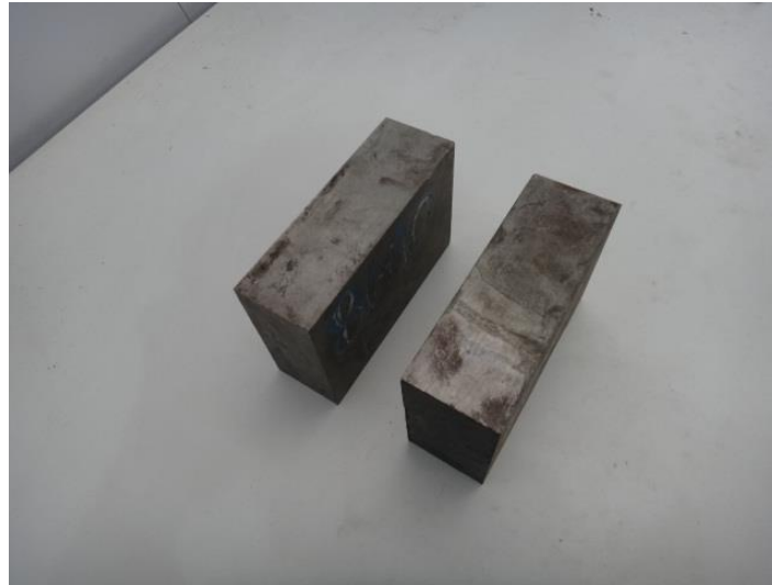
Figura 3.3 - Corpos de prova de aço SAE 8640. Fonte: Próprio Autor.
