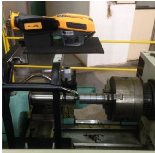
Figura 33. Posicionamento da Câmera Térmica no torno (Fonte: Autores, 2017).
