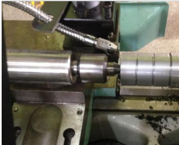
Figura 37. Torneamento cilíndrico externo com jorro aço SAE 1045 (Fonte: Autores, 2017).
