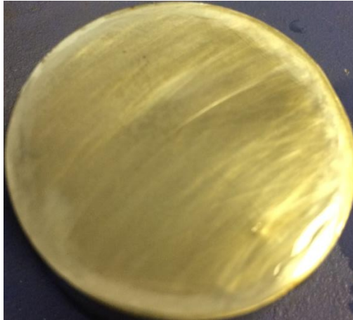
Figura 48. Evolução da superfície do material após o lixamento com lixas de mesh 100, 240 e 320 (Fonte: Autores, 2017).
