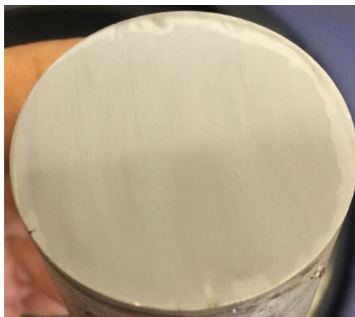
Figura 54. Evolução da superfície do material após o lixamento com lixas de mesh 100, 240 e 320 (Fonte: Autores, 2017).
