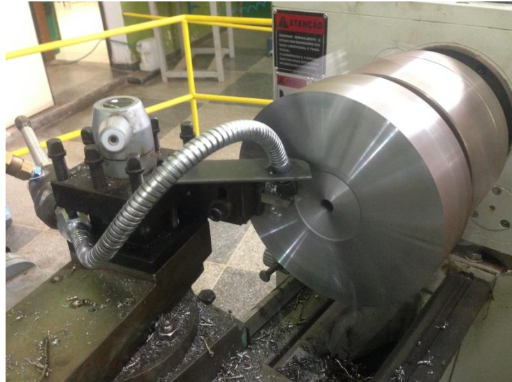
Figura 6. Faceamento rápido com utilização do Tubo Vórtices.
