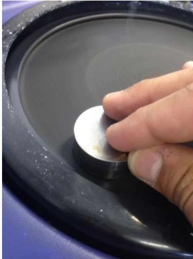
Figura 47. Procedimento de lixamento superficial da peça (Fonte: Autores, 2017).
