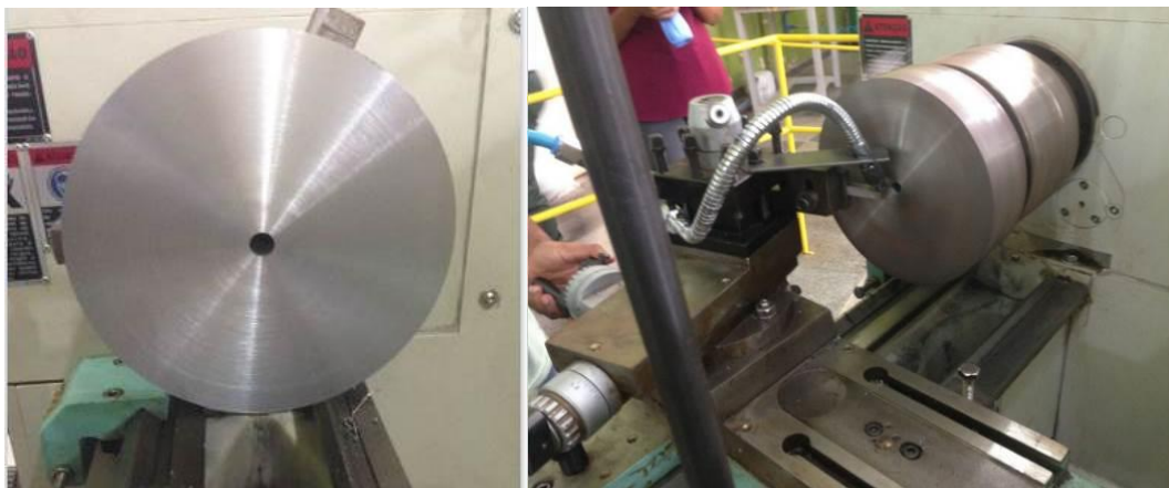
Figura 27. Montagem do experimento de faceamento rápido (Fonte: Autores, 2017).
