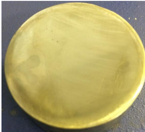
Figura 49. Evolução da superfície do material após o lixamento com lixas de mesh 400, 600, 800 e 1200 (Fonte: Autores, 2017).
