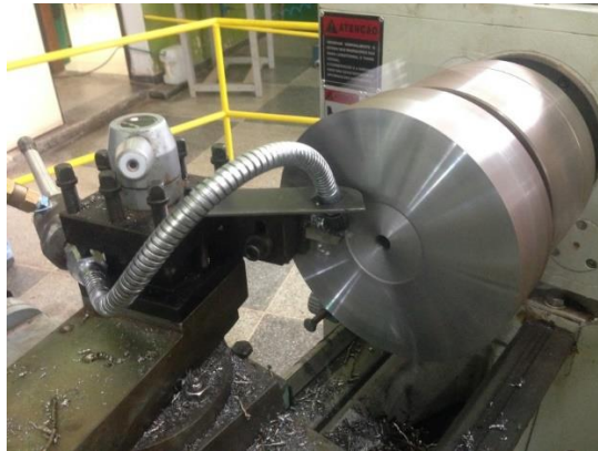
Figura 31. Faceamento rápido com utilização do Tubo Vórtices (Fonte: Autores, 2017).
