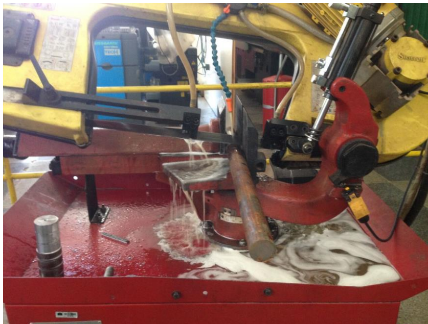
Figura 41. Corte da amostra do tarugo de ferro fundido para ensaio (Fonte: Autores, 2017).
