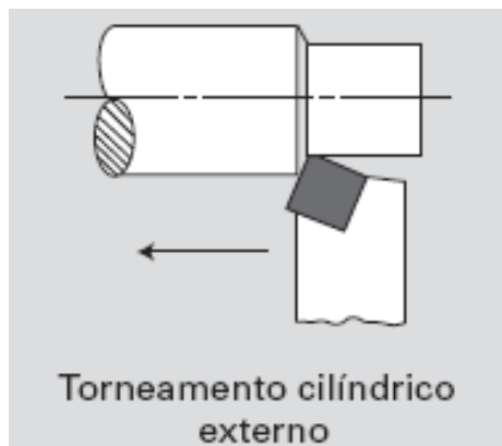
Figura 1. Ferramenta de corte fixa e peça em rotação (Fonte: Adaptado de Machado et. al. , 2015).
