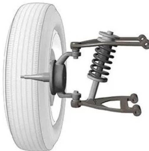
Figura 11. Suspensão Duplo A. Fonte: www.abrilquatorrodas.com.br
