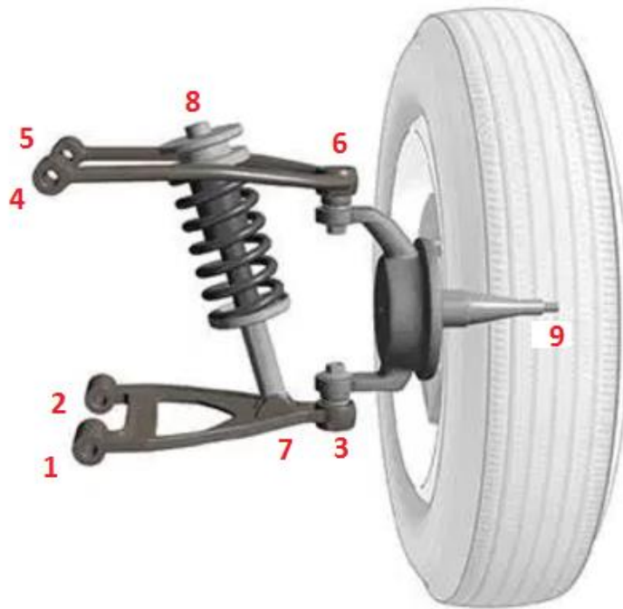
Figura 22: hardpoints de uma suspensão Duplo A. Fonte: www.abrilquatorrodas.com.br (modificado).
