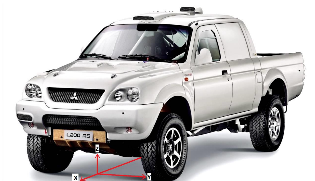
Figura 29: Origem do referencial para os hardpoints . Fonte: www.en.wheelsage.org (modificado)
