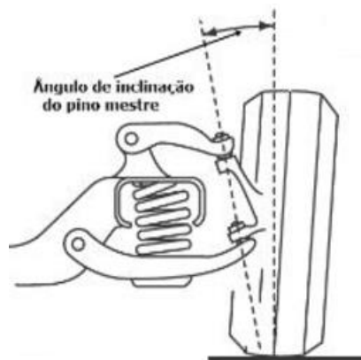
Figura 18: Inclinação do pino mestre. Fonte: www.autoentusiastasclassic.com.br
