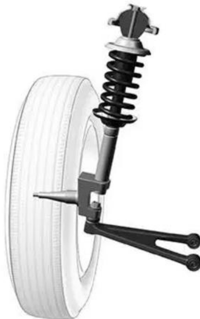
Figura 8. Suspensão MacPherson . Fonte: www.abrilquatrorodas.com.br
