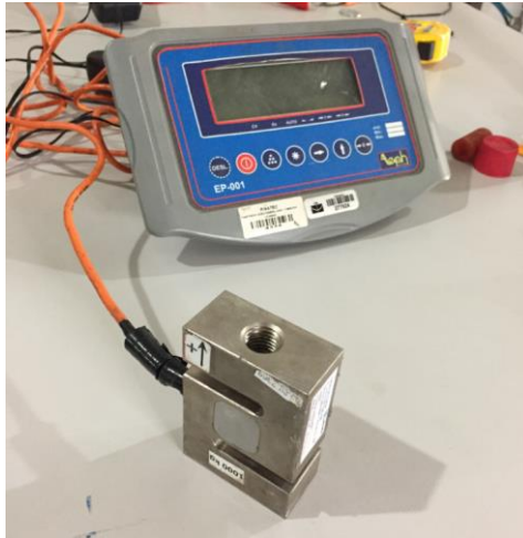
Figura 26: Célula de carga utilizada na pesagem.
