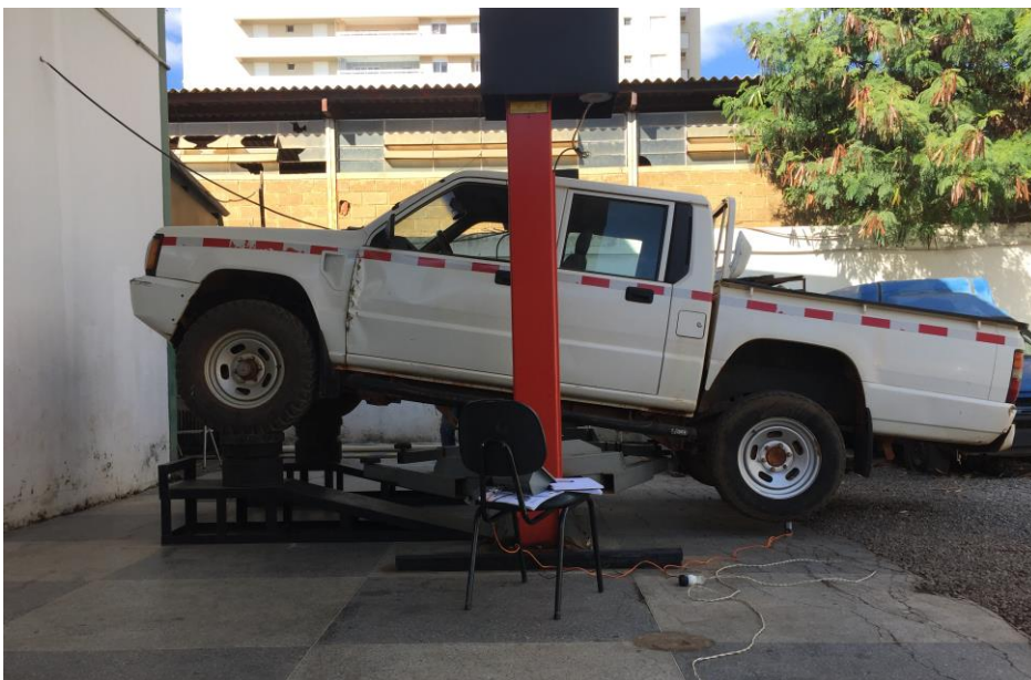
Figura 27: Pesagem do veículo a um ângulo pré-determinado.
