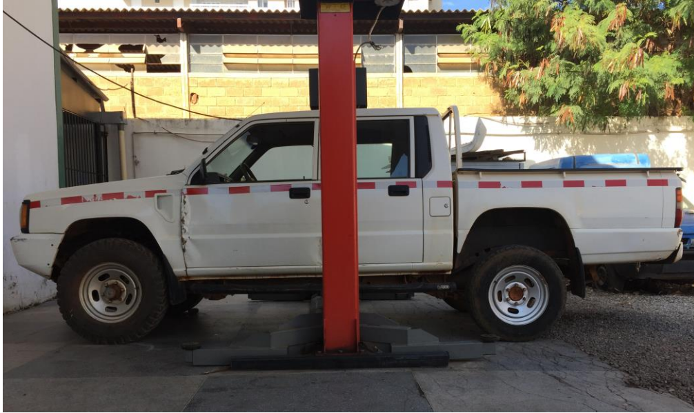
Figura 24: Pesagem do veículo na horizontal.
