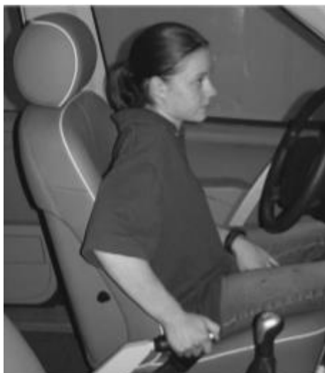
Figura 16. Voluntária de baixa estatura avaliando a posição de direção e alcance dos instrumentos em um mock-up estático físico. (Fonte: HERRIOTTS & JOHNSON, 2013).
