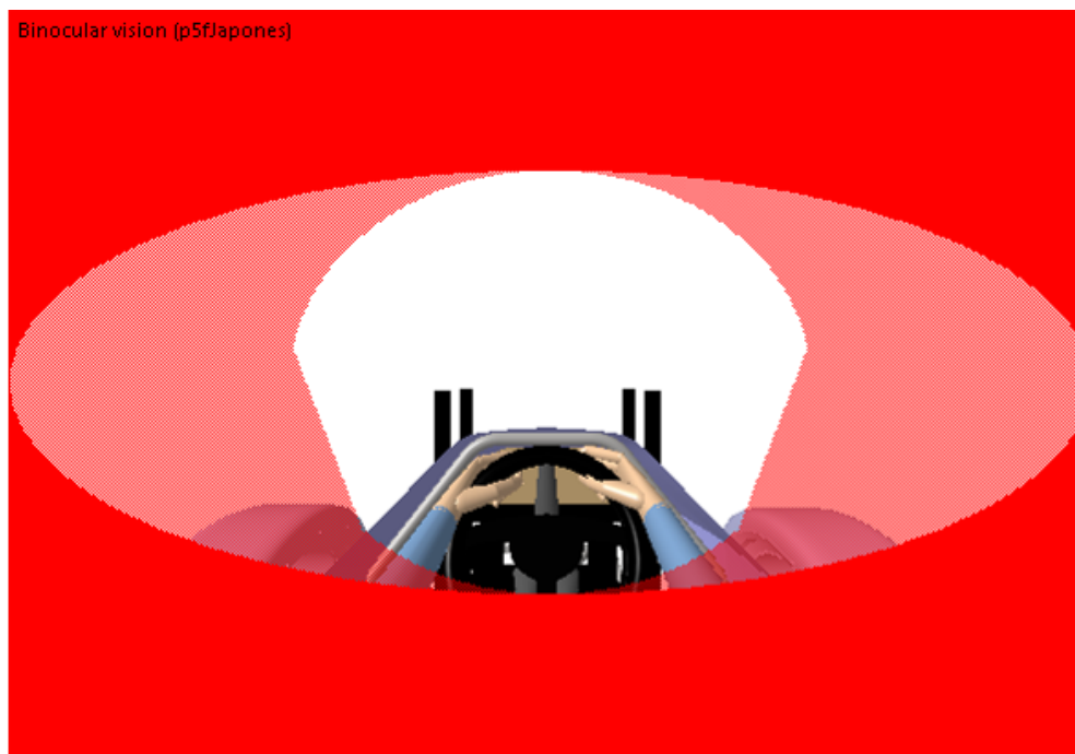
Figura 51. Visão do ponto de vista manequim Feminino Percentil 5%, que está dentro da bancada que está dentro do veículo como forma de comparação (Fonte: Autores, 2017).
