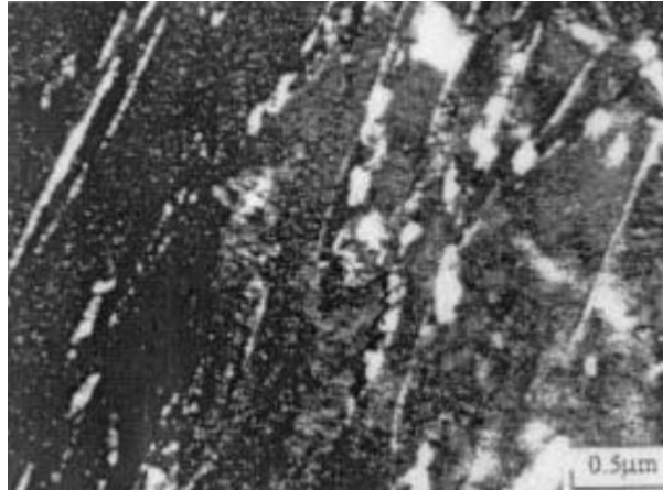
Figura 6. Estrutura da martensita do aço AISI 4340 revenido a 300°C (Lee e Su, 1997).
