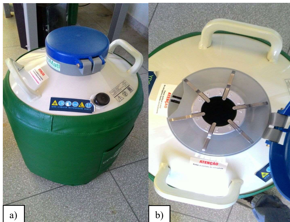
Figura 20. (a) Formato e (b) tampa do Botijão YDS 20-50 da Cryofarm (Próprio Autor, 2017).
