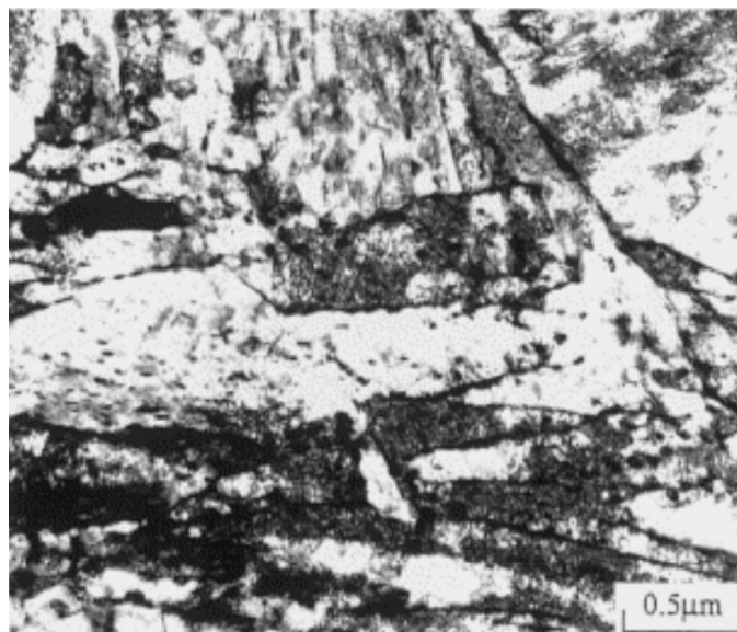
Figura 9. Micrografia de um aço AISI 4340 temperado em óleo (850°C/30min) e revenido a 200°C por 2 horas (Lee e Su, 1997).
