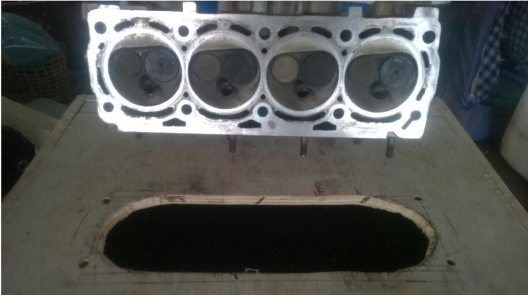
**Figura 15 – Abertura de conexão do plenum ao cabeçote**
