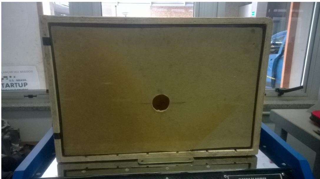
**Figura 16 – Base inferior do Plenum com a abertura de conexão com a bancada.**
