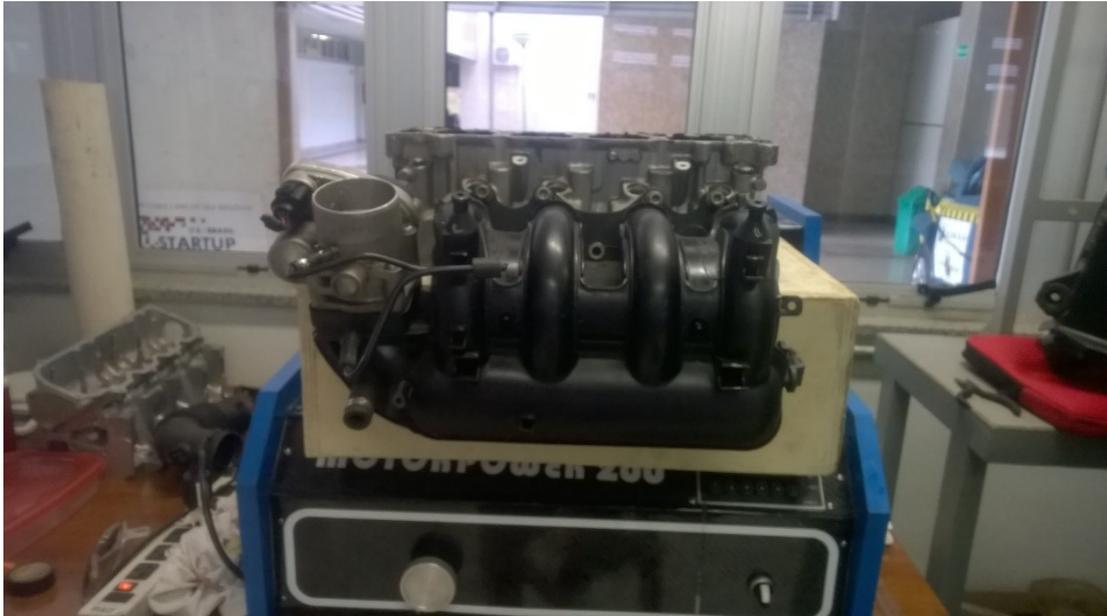
**Figura 18 – coletor de Admissão instalado ao cabeçote**
