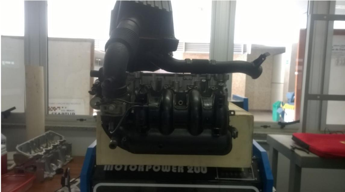
**Figura 20– Filtro de Ar conectado ao coletor e suas conexões**
