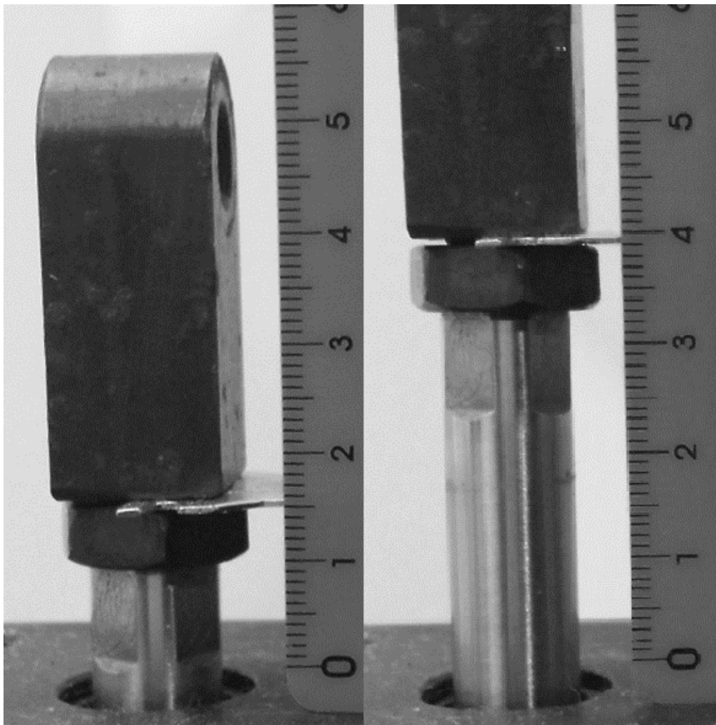
Figura 6.3 – Esquema de aferição dos deslocamentos, Medida inicial igual a 15,0 \pm 0,5 \text{ mm} e Medida final igual a 39,0 \pm 0,5 \text{ mm} , deslocamento de 24 \pm 1 \text{ mm} .
