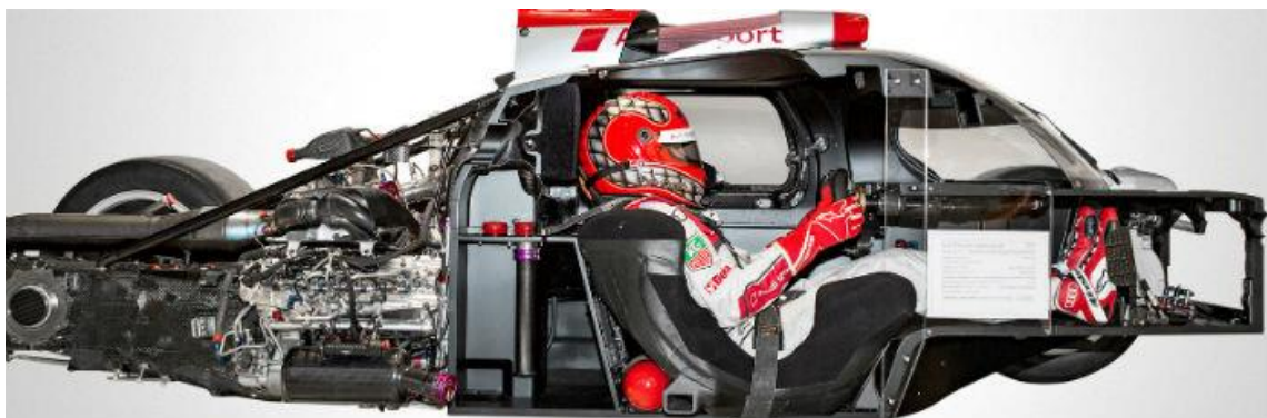
Figura 1 - Vista em corte de um carro do WEC (world endurance championship). (racecar-engineering, 2015).
