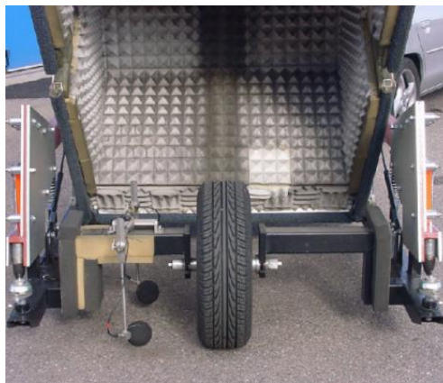
Figura 32 - Medição de ruído pelo método CPX (SLAMA, 2012).
