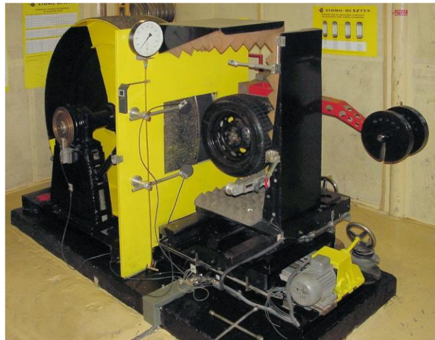
Figura 35 - Dispositivo de teste de ruído pneu-pavimento pelo método do tambor giratório (SANDBERG et al. , 2013).
