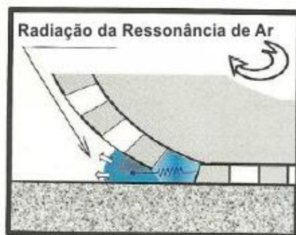
Figura 16 - Radiação da ressonância de ar na parte traseira do pneu (SILVA, 2011) (Adaptado).
