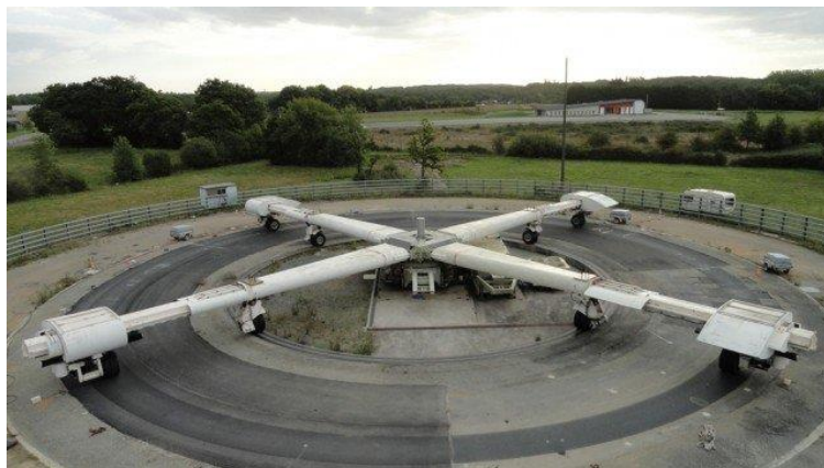
Figura 36 - Dispositivo para teste de durabilidade de pavimentos (CORTÉ, 2001).
