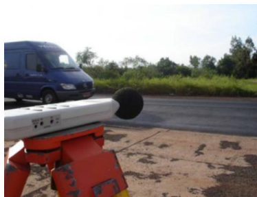
Figura 5 - Medição de ruído pelo método estatístico de passagem (SPECHT et al. , 2009).
