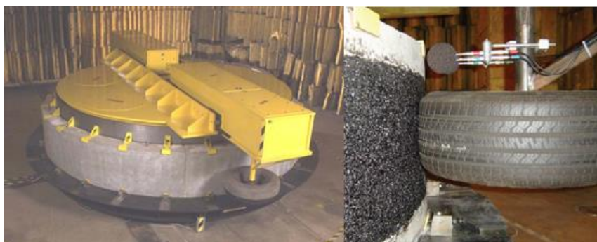
Figura 34 - Dispositivo para teste de ruído pneu-pavimento em laboratório (BERNHARD et al. , 2005).
