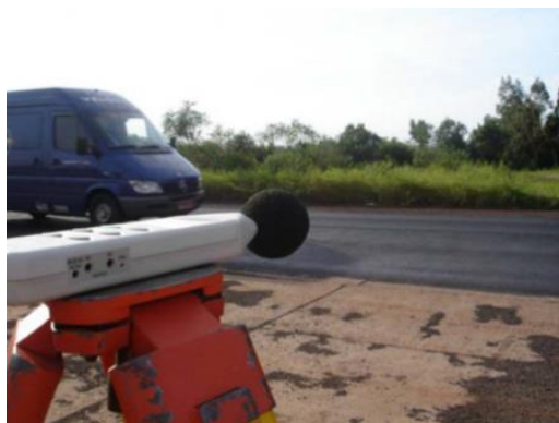
Figura 29 - Medição de ruído pelo método estatístico de passagem (SPECHT et al. , 2009).
