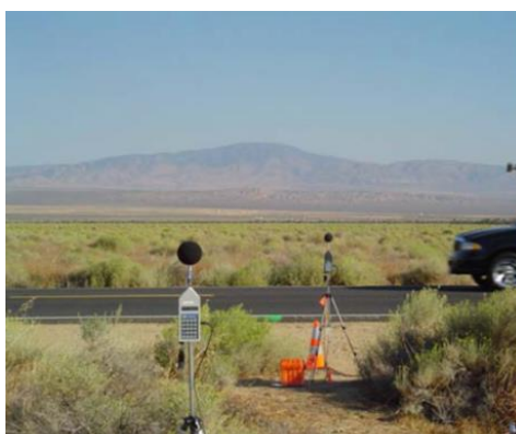
Figura 30 - Medição de ruído pelo método controlado de passagem (Judith Rochat, U.S. DOT Volpe Center apud BERNHARD et al. , 2005).
