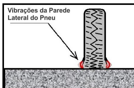
Figura 12 - Vibrações da parede lateral do pneu (SANDBERG et al. , 2002 apud BERNHARD et al. , 2005) (Adaptado).
