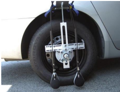
Figura 31 - Medição de ruído pelo método CPI (WANG et al. , 2012).
