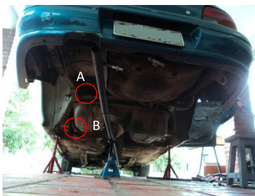
Figura 42 - Subaru Impreza em elevação com suspensão traseira desconectada
