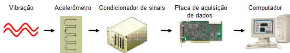
Figura 2-16 - Cadeia de instrumentação para aquisição de dados de vibração (adaptado de (Serrano, et al., 2004))
