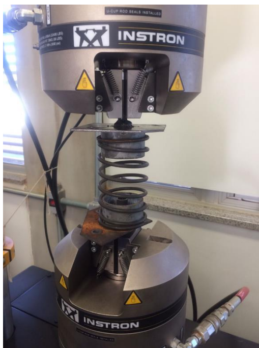
Figura 3-8 - Suporte para adaptação da mola na máquina de ensaio de compressão
