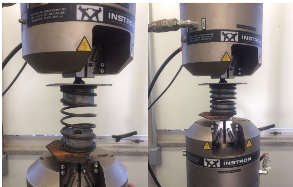
Figura 3-9 – Comparativo entre a mola em seu estado original e após a compressão de 45mm
