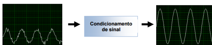
Figura 2-18 - Exemplo de condicionamento de sinal: Amplificação e Filtragem (Serrano, et al., 2004).
