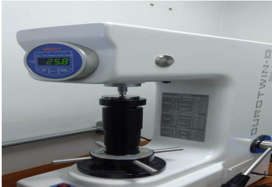
Figura 3.3 – Funcionamento do microdurômetro durante o ensaio. Fonte: Próprio autor.
