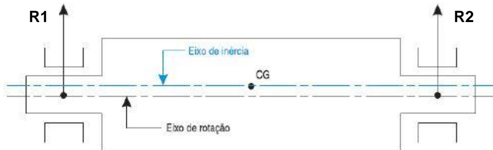
Figura 9. Resultantes nos mancais provocadas por desbalanceamento estático. FONTE: (COELHO, 2013).
