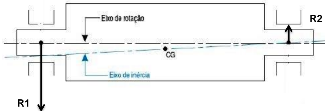
Figura 17. Resultantes nos mancais devido ao desbalanceamento dinâmico. FONTE: (adaptado: COELHO,2013).
