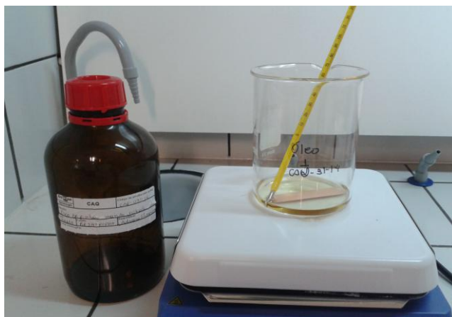
Figura 10. Oxidação na lâmina de cobre.
