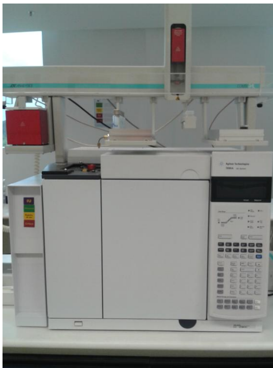
Figura 16- Cromatógrafo à gás utilizado no teor de éster.
