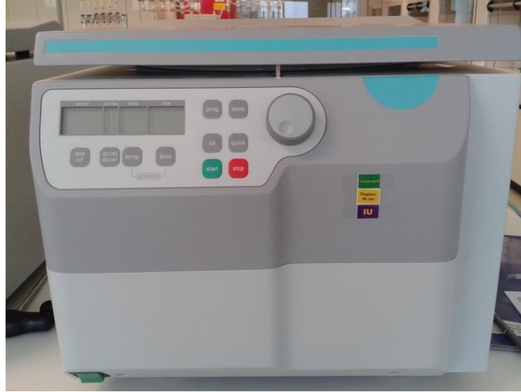
Figura 13- Centrifuga utilizada na separação do biodiesel.
