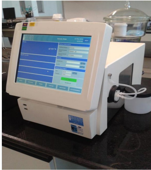
Figura 7- Densímetro Digital utilizado na análise de densidade.
