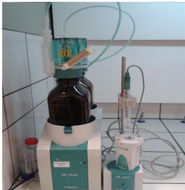
Figura 8- Titulador potenciométrico utilizado nas análises químicas de acidez.
