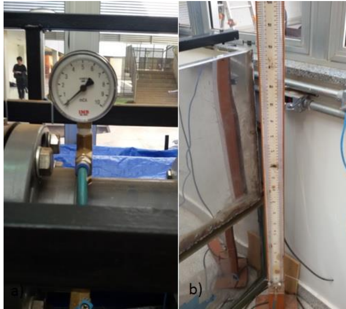
Figura 19. Medidores de pressão: a) analógico; b) de coluna d'água.
