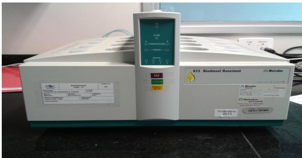
Figura 12 - Equipamento da marca Metrohm destinado à obtenção da estabilidade oxidativa da amostra.
