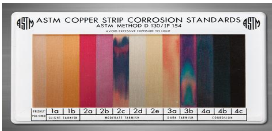
Figura 11 - Referencial padrão para análise de corrosão ao cobre.
