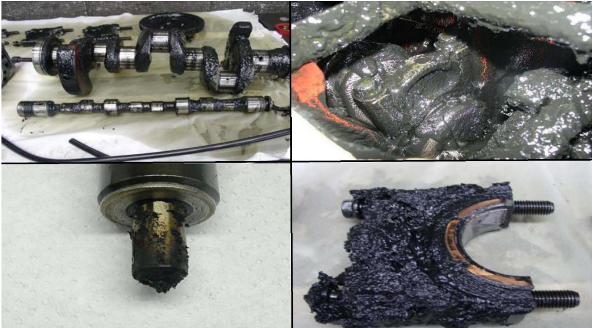
Figura 6: Motor MWM após funcionamento com óleo in natura por período de 60 horas. (Fonte: METALSINTER, 2011)
