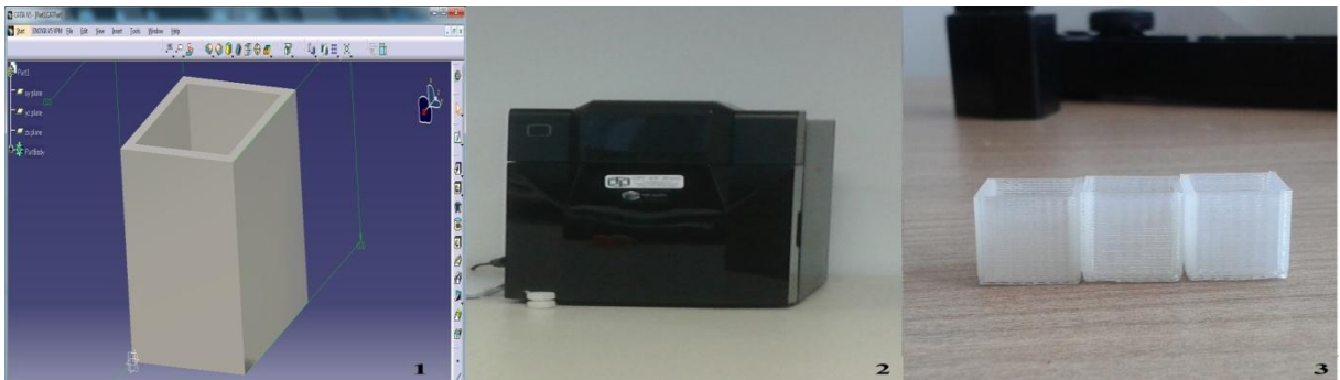
Figura 5.9- 1) Desenho no Catia; 2) Impressora UP3D; 3) Peças no formato do cubo em PLA.
