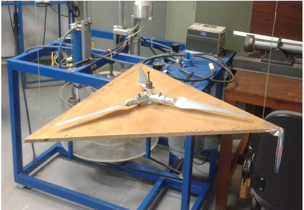
Figura 4.10 – Ensaio do rotor hidrocínético no pêndulo torcional trifilar.
