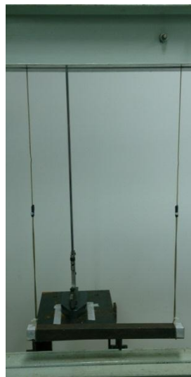
Figura 3.4 – Bancada experimental suspensa pelos dois fios utilizada durante a realização do experimento.
