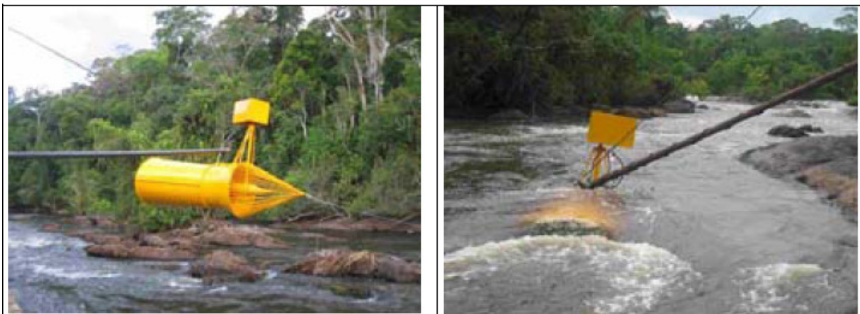
Figura 14 – THC de segunda geração aplicada no rio Caranã. Fonte: (Els, 2008).
