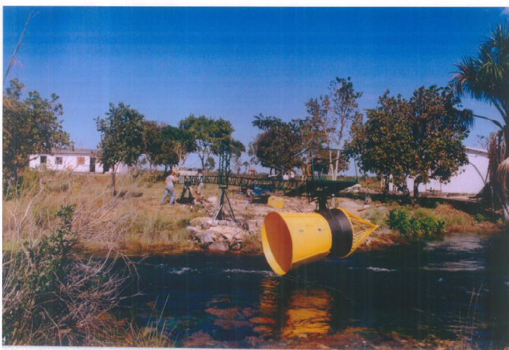
Figura 10 – Segunda geração de THC em operação e desenho técnico. Fonte: (Campos, 2015).
