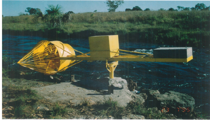
Figura 7 – Terceira turbina hidrocínética desenvolvida pela UnB. Fonte: (Campos, 2015).
