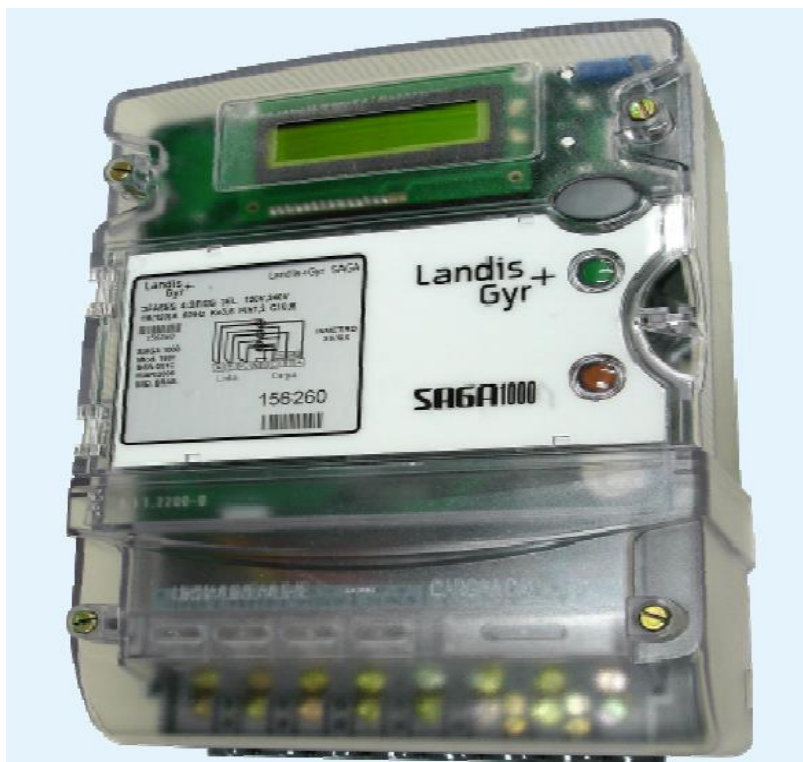
Figura 16. Medidor de energia SAGA-1000. Fonte: (LANDIS+GYR, 2006)
