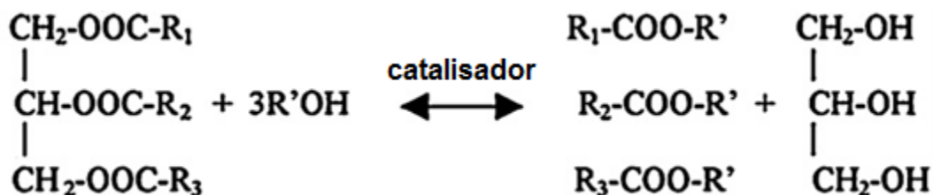
Figura 3 - Reação química estequiométrica de transesterificação. Adaptado de (Shahid & Jamal, 2011).
