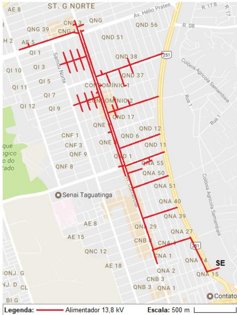
Figura 12 - Percurso do Alimentador TG01 com suas ramificações.
